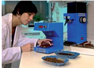
Farbmessgerät für die Qualitätskontrolle von Röstkaffee
