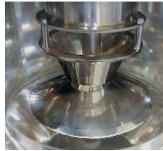
Rotospray® – Mikrodosiersystem für Flüssigkeiten
