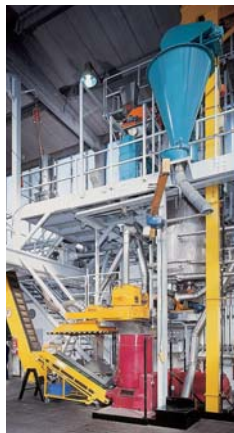
KAHL Versuchsanlage: Dosierung, Durchlaufmischer, Hydrothermischer Reaktor, Ringspalt-Expander® Extruder OEE, Flachmatrizenpresse, Bandrockner/Kühler, Rotospray®, Granulierstuhl, Brechwalzenstuhl
