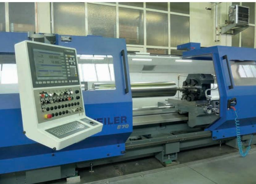
Maschine 2: Drehmaschine Weiler E70-3000
