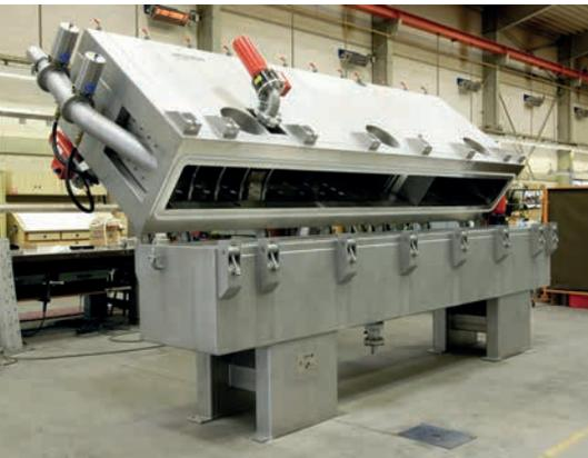
Das Wirbelschicht-Element ist abklappbar und gibt den Zugang zur Siebboden frei
