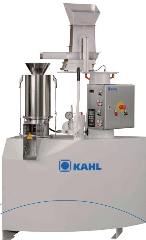
Flachmatrizenpresse Type 14-175 für den Laboreinsatz oder für Kleinproduktionen.
