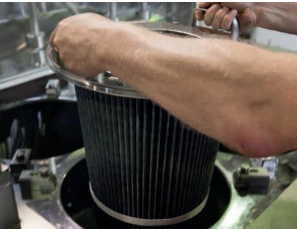
Der Zugang auf zwei Ebenen erleichtert beispielsweise den Filteraustausch
