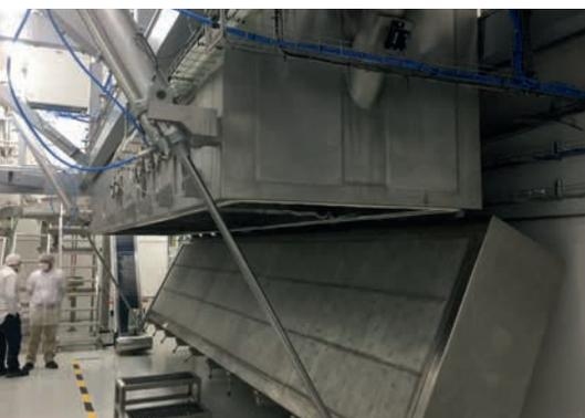
Bei NEUHAUS NEOTEC Conti FB Wirbelschichtanlagen gibt es verschiedene Varianten für die Entnahme innen liegender Produktfilter. Bei der klassischen Variante wird die Ablufthaube schräg aufgeklappt, um einen bequemen Zugang sowohl zum Anströmboden als auch den Filtern zu erhalten. Um den Zugang zu erhalten, muss die Anlage vorher komplett entleert werden.
