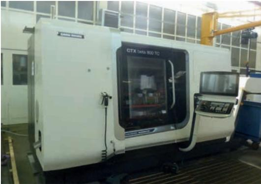
Maschine 1: Drehmaschine DMG Mori CTX beta 800
