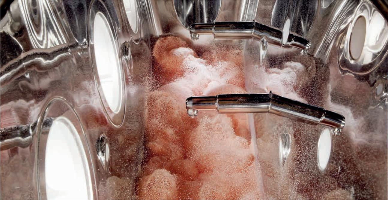
In der Wirbelschicht herrschen optimale Bedingungen für einen effektiven Stoff- und Wärmeaustausch
